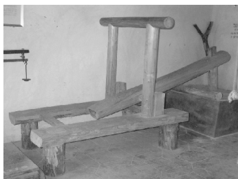
碓，木制碓米用的工具。接触米的木头上镶有一节铁的白头。
