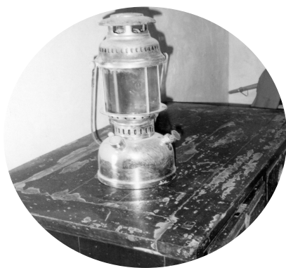
汽灯。使用时打开红盖，往里打气。
